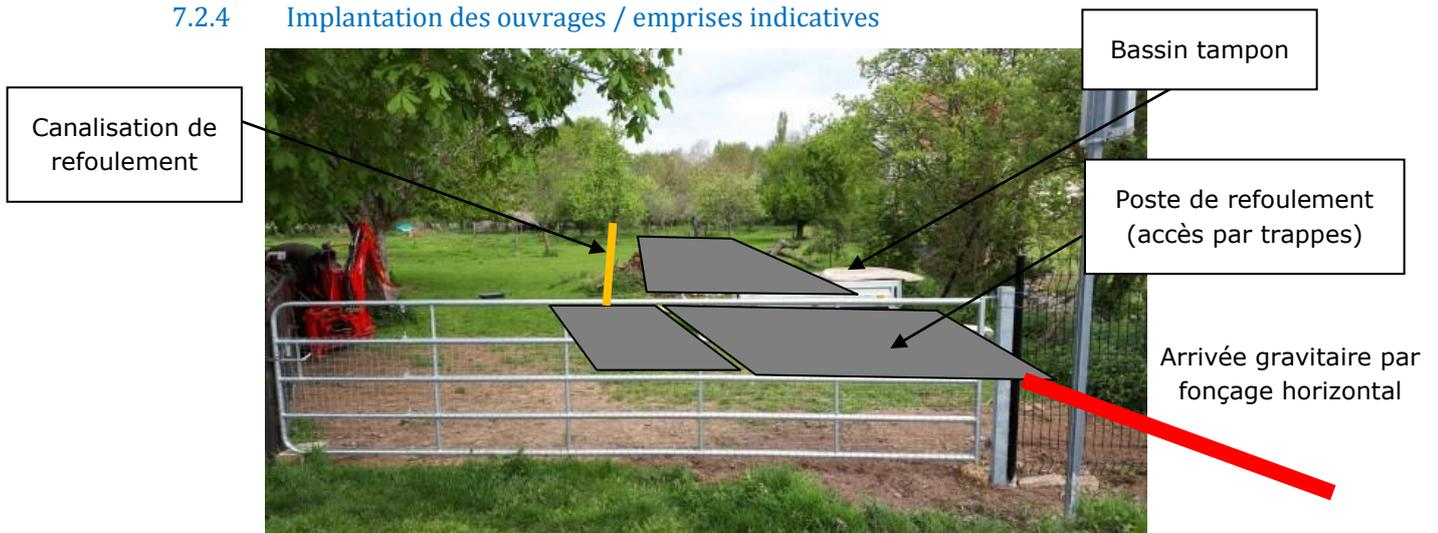
Implantation schématique : poste de refoulement + bassin tampon en domaine privé (clôturé)
